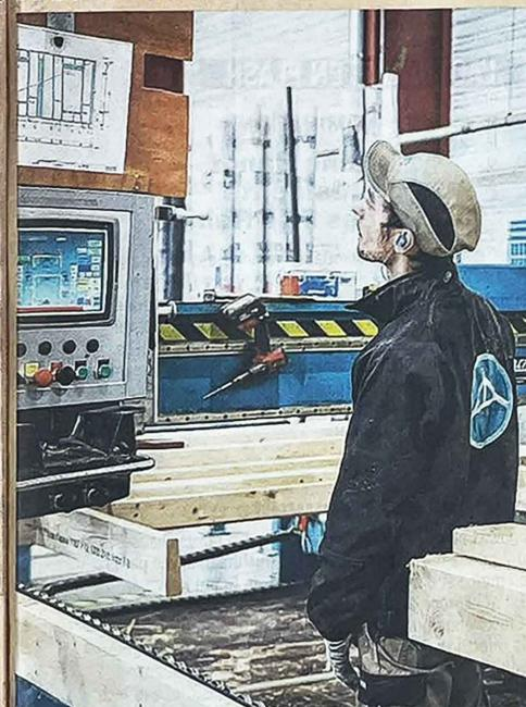
C'est une machine qui assemble et fixe les éléments des ossatures bois.
